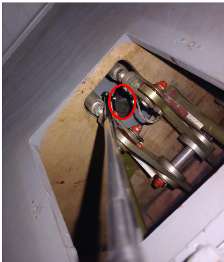
Obr. 11 - Pohled v zrcátku na kladku za přepážkou č. 8
