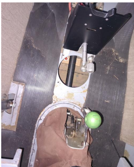
Obr. 5 - Kruhový kryt na podlaze mezi přepážkami č. 3 a 4
