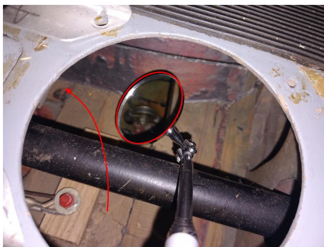
Obr. 10 - Pohled v zrcátku na kladku za přepážkou č. 3
