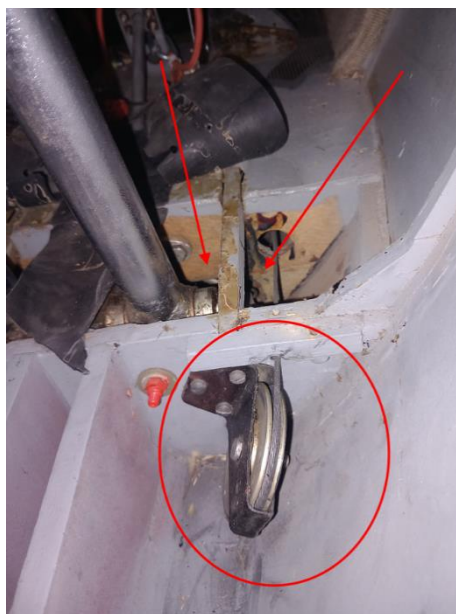
Obr. 9 - Kladka nožního řízení na přepážce č. 2
