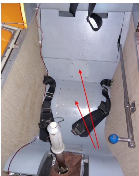
Obr. 6 - Kryty na sedačce pilota a opěrce zad
