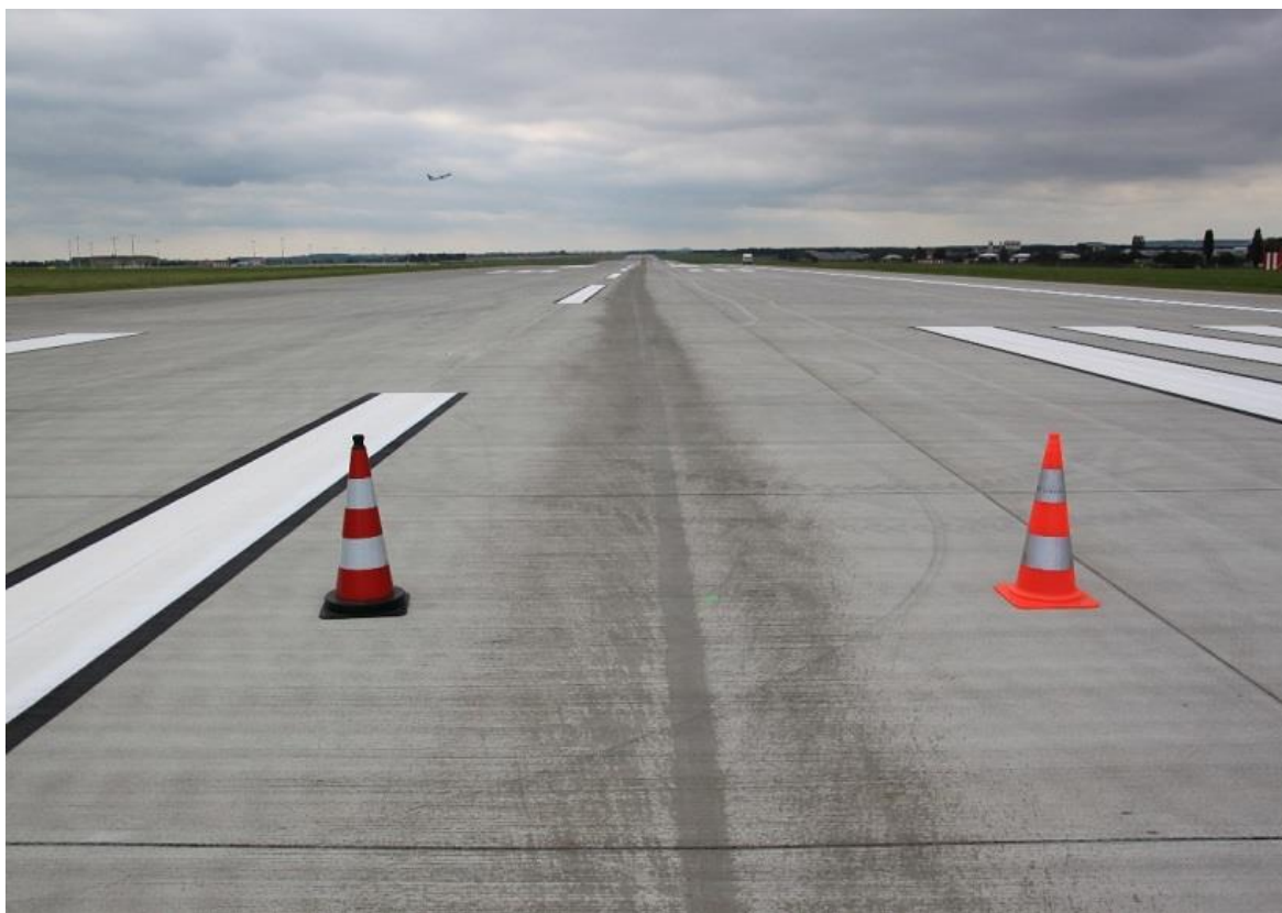
Obr. 3 – Vzdálenost od osy dráhy pro měření charakteristik tření
