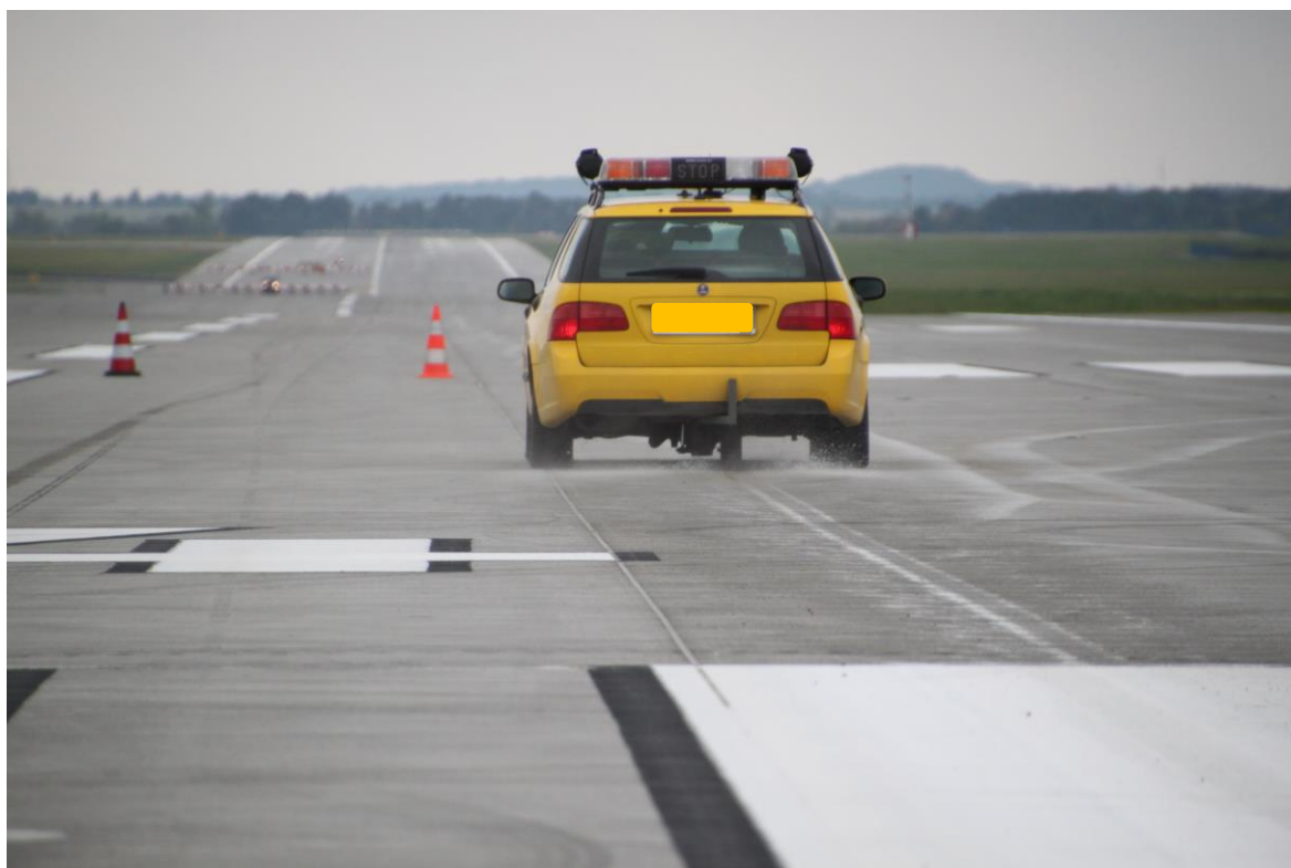
Obr. 1 – SARSYS Friction Tester s aktivovaným samoskrápěním
